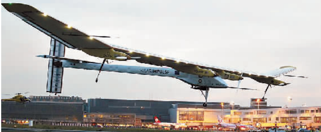
5月13日晚,世界最大的太阳能飞机——瑞士制造的“太阳驱动”号飞抵布鲁塞尔国际机场。当天,“太阳驱动”号太阳能飞机用12小时59分飞行630公里,从瑞士帕那那机场起飞,途经法国和卢森堡,抵达布鲁塞尔,成功完成首次跨国飞行。“太阳驱动”号自身重量约1600公斤,翼展长度为63.4米,机翼上覆盖着1.2万个太阳能电池板,为飞机上总重达400公斤的4个蓄电池充电。(据网易)
