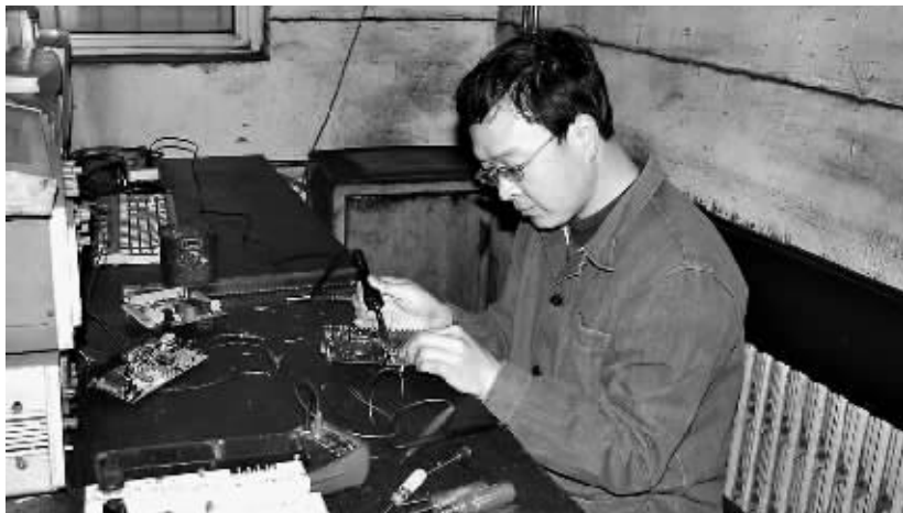
闫军在检修低压馈电开关电子保护装置。晨报记者 李丹丹 摄
