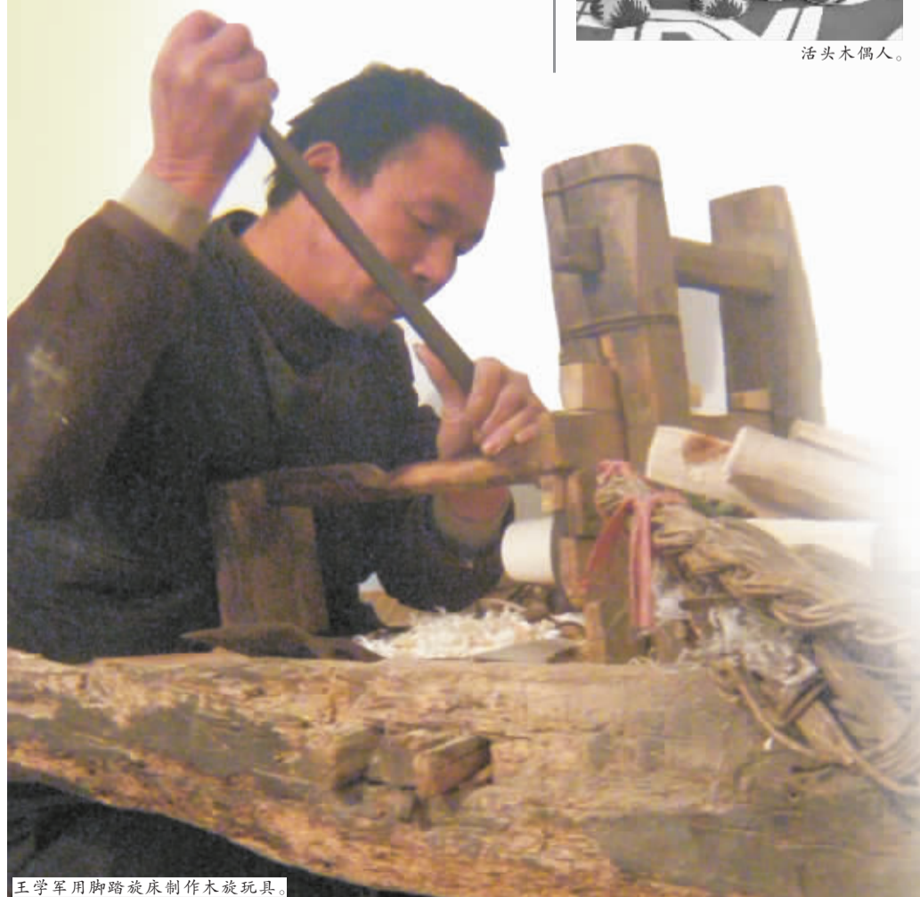
王学军用脚踏旋床制作木旋玩具。
