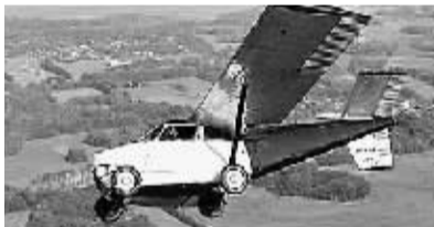
▲“空中轿车”在3600米的空中时速可达177公里,在公路上的最大时速为96公里。
