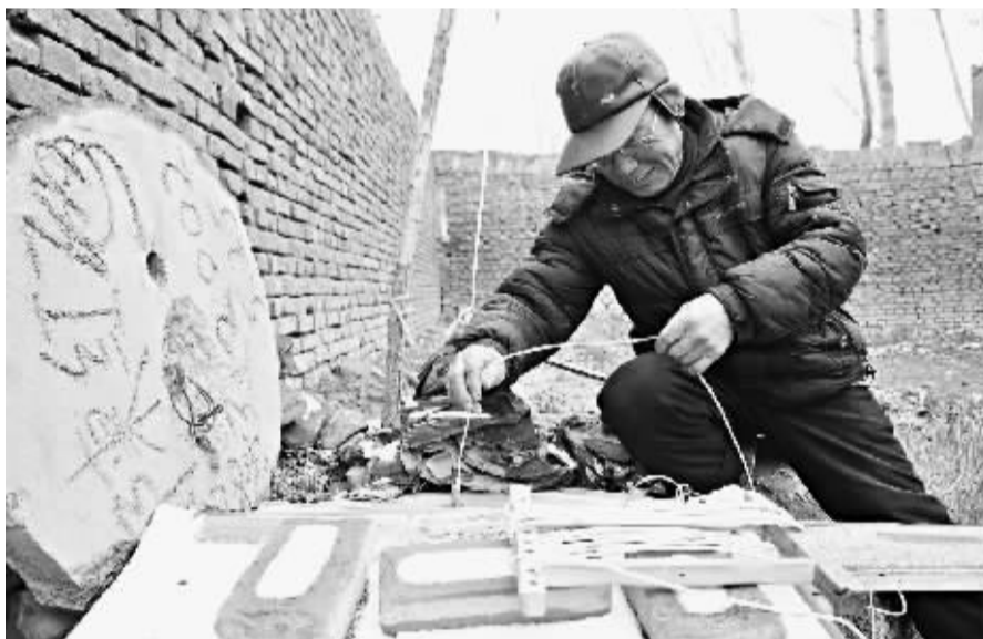
闫振太将电线放入井中测量水位。
