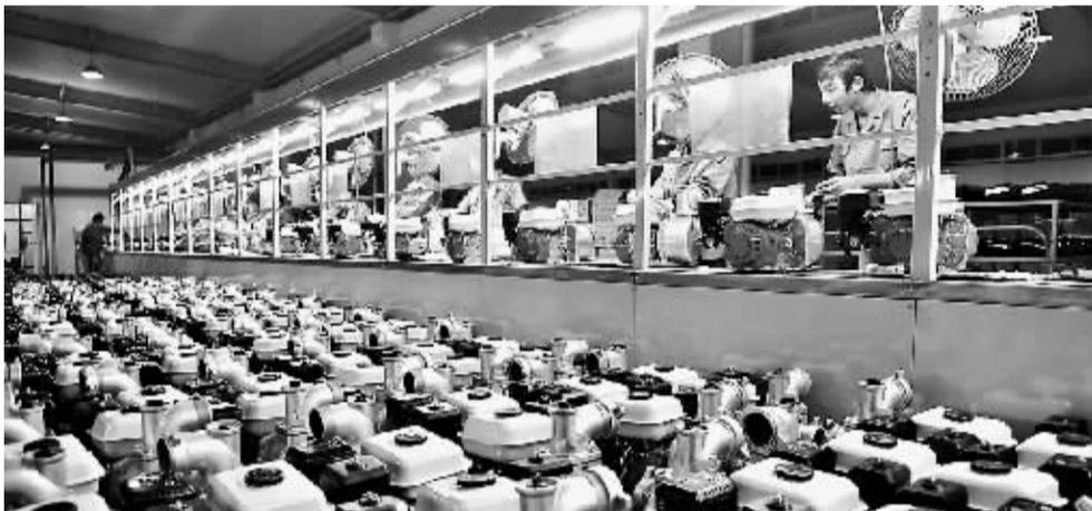
河南创世电机科技有限公司镁合金材料进一步应用到发电机组的箱体、高盖、低盖、支架、缸头等关键位置,代替传统的铁件、铝合金零部件。丰富了我市金属镁深加工终端产品种类,拉长了产业链条。图为该公司发电机生产车间。
