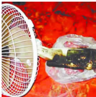
燃烧后的电风扇。
