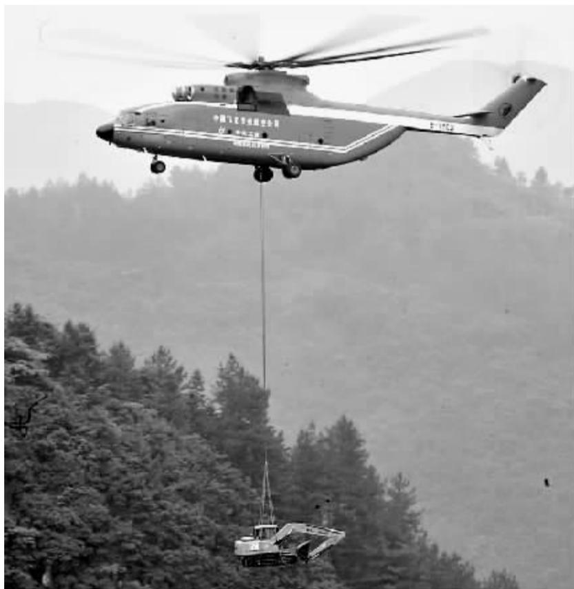
6月11日,米-26直升机在进行一次试飞之后,按照飞行计划开始有序吊运大型救援设备到武陵山体垮塌抢险救援现场。截至记者中午发稿时,米-26直升机共吊运4台挖掘机和1台空压机。
